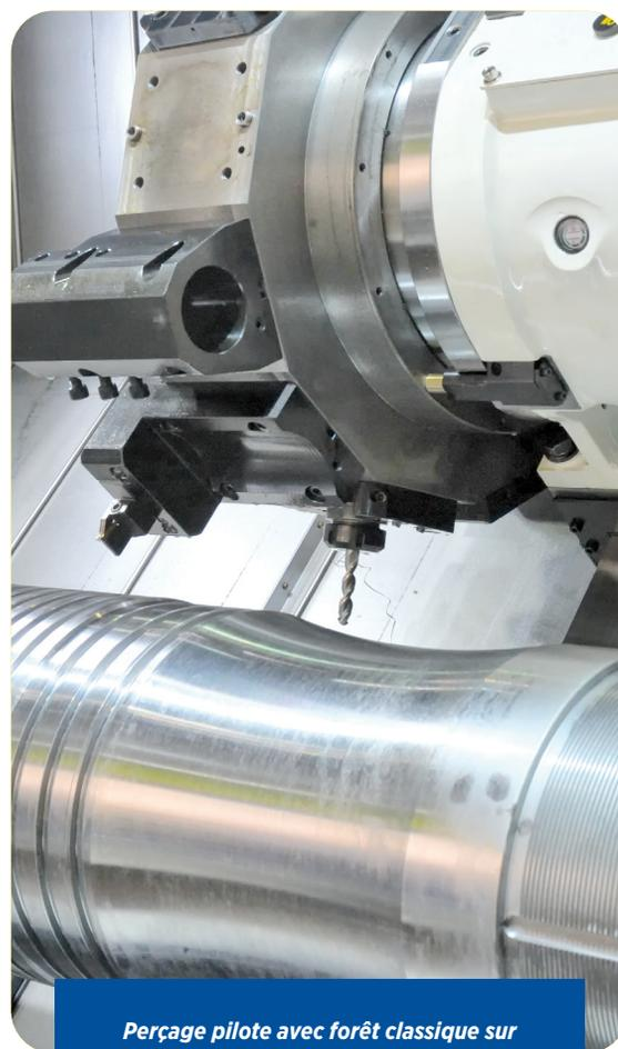
*Perçage pilote avec forêt classique sur surfaces concaves et convexes.*
