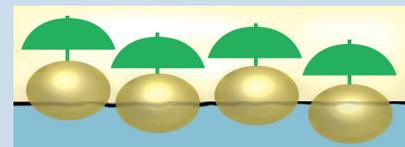
Simultanément, les molécules d'ÉTERNA® 3000 vont réagir et être fortement adsorbées sur les surfaces engendrées par la coupe. Elles vont ainsi abaisser considérablement le coefficient de frottement.
